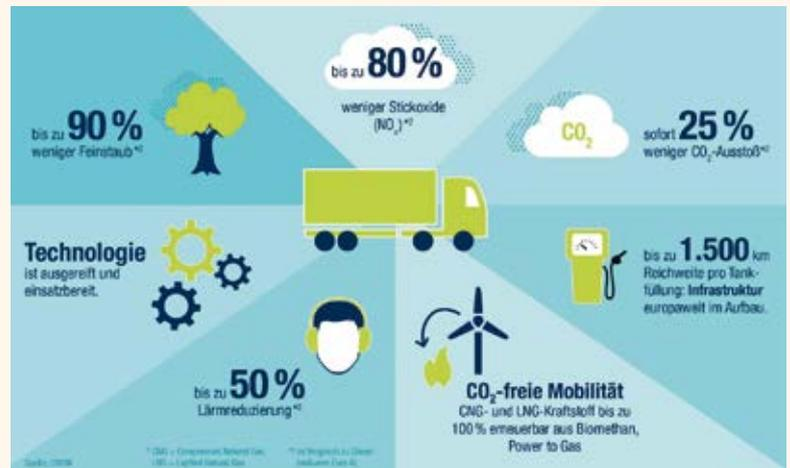
**CNG- und LNG-Antrieb: viele Vorteile, besonders für den Güterverkehr, der aktuell von Dieselantrieben dominiert wird. Die Werte für Schadstoff- und Lärmreduzierung bilden den Vergleich zu Diesel (inklusive Euro 6).**
